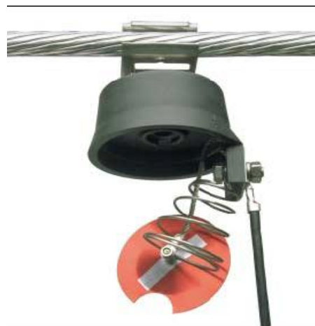
Kvar – odvodnik odvojen od mreže
